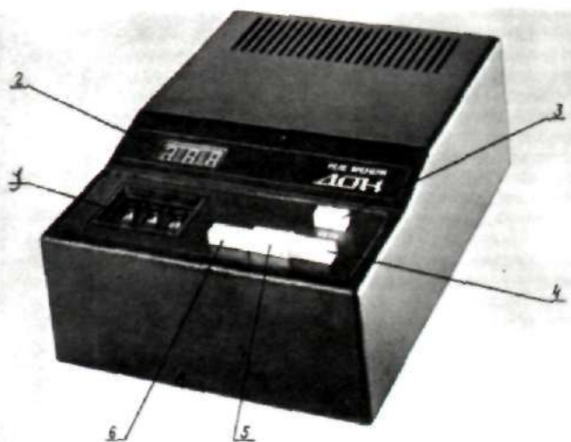
ФОТО 1. РЕЛЕ ВРЕМЕНИ «РВ ДОН-15К». 1 — ТРЕХДЕКАДНЫЙ МУЛЬТИПЕРЕКЛЮЧАТЕЛЬ ВВОДА ВРЕМЕНИ ЭКСПОНИРОВАНИЯ; 2 — ТРЕХДЕКАДНОЕ ЦИФРОВОЕ ТАБЛО ВРЕМЕНИ; 3 — КНОПКА ВКЛЮЧЕНИЯ РЕЛЕ; 4 — КНОПКА «ПУСК»; 5 — КНОПКА «СТОП»; 6 — КНОПКА ВКЛЮЧЕНИЯ ЛАМПЫ ПРИ КАДРИРОВАНИИ
