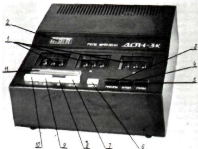
ФОТО 2. РЕЛЕ ВРЕМЕНИ «РВ ДОН-36К». 1 — ТРИ ТРЕХДЕКАДНЫХ МУЛЬТИПЕРЕКЛЮЧАТЕЛЯ ВВОДА ВРЕМЕНИ ЭКСПОНИРОВАНИЯ; 2 — ЦИФРОВОЕ ТАБЛО; 3 — КНОПКА ВКЛЮЧЕНИЯ ЛАМПЫ ПРИ КАДРИРОВАНИИ; 4 — КНОПКА «СТОП»; 5 — КНОПКА «ПУСК»; 6 — КНОПКА ВКЛЮЧЕНИЯ РЕЛЕ; 7 — КНОПКА ВКЛЮЧЕНИЯ КАНАЛА ЧЕРНО-БЕЛОЙ ПЕЧАТИ; 8 — КНОПКА ВКЛЮЧЕНИЯ «СИНЕГО» КАНАЛА; 9 — КНОПКА ВКЛЮЧЕНИЯ «ЗЕЛЕННОГО» КАНАЛА; 10 — КНОПКА ВКЛЮЧЕНИЯ «КРАСНОГО» КАНАЛА; 11 — ПАНЕЛЬ СВЕТОДИОДНЫХ ИНДИКАТОРОВ ВКЛЮЧЕННОГО КАНАЛА
